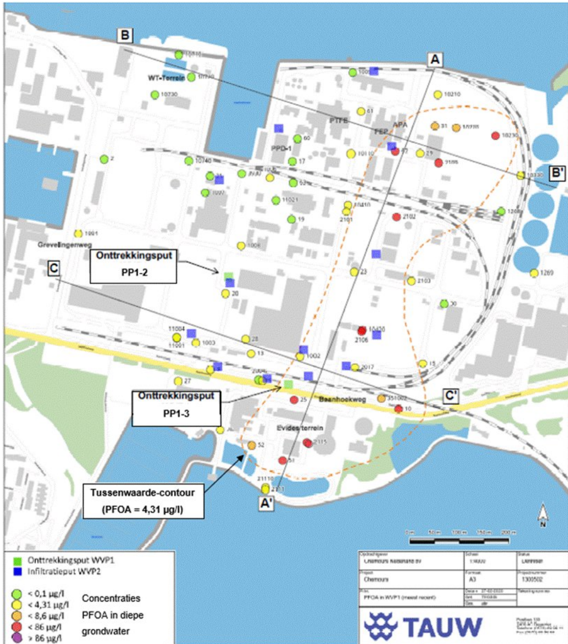
Bijlage 3) Situatietekening met bodemverontreiniging met PFOA in het diepe grondwater (WVP1) (incl. onttrekkingsputten van het grondwaterbeheerssysteem)
