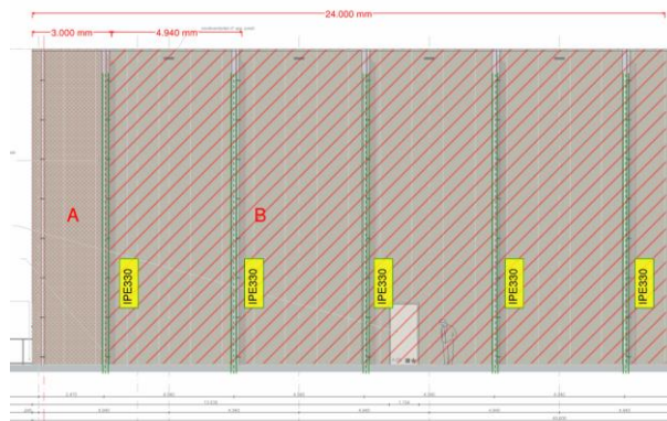
Zones t.b.v. drukcoëfficiënten bij brandwand
