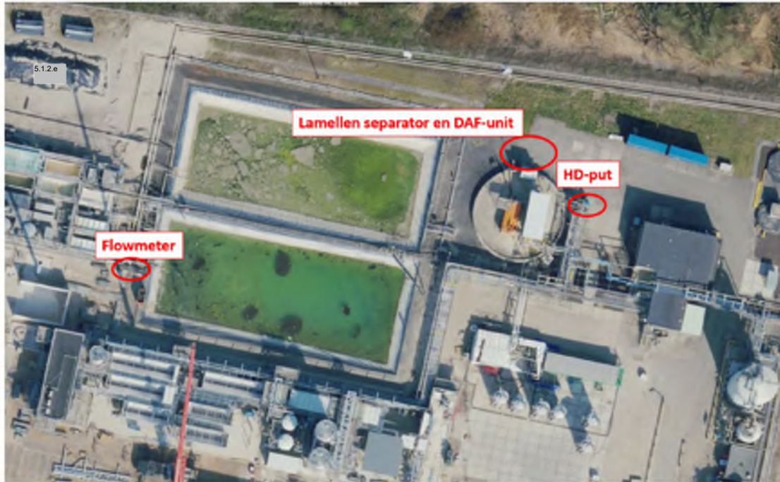
Figuur 5.2 Situering lamellen separator, flowmeter, DAF-unit en HD put op het WT terrein (luchtfoto Cyclomedia Streetsmart 2023)
