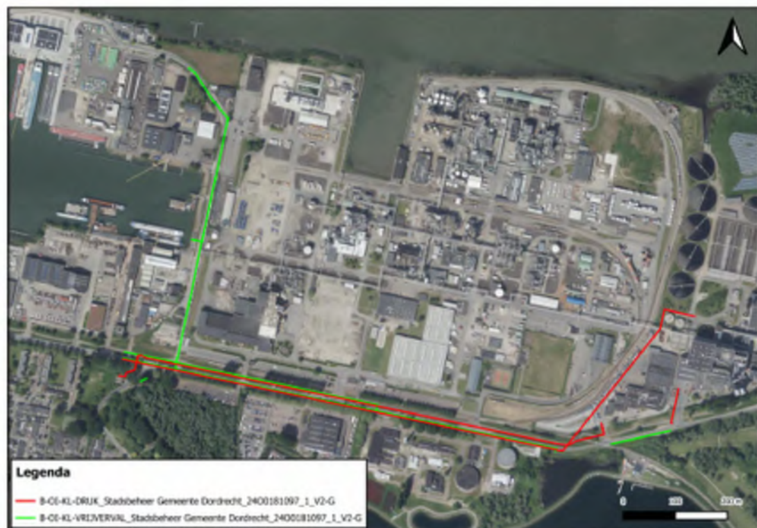
Figuur 4.5 Ligging gemeentelijk riool (Rode en groene lijnen) waardoor bij de WT gezuiverd afvalwater van het Chemours-terrein is/wordt afgevoerd naar de RWZI van WSHD aan de oostzijde van het terrein
