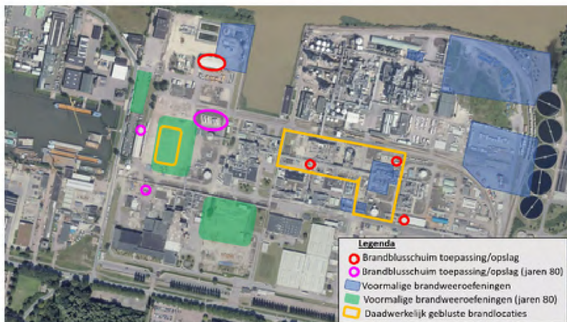
Figuur 4.18 Gebruik (vermoedelijk)PFAS houdend brandblusschuim op het Chemours-terrein. De tijdsaanduiding tussen jaren '80 en andere brand(oefeningen) was de enige tijdsaanduiding die destijds in de interviews gegeven kon worden. Als er geen aanduiding bij staat is dit niet meer te achterhalen geweest en alleen bekend dat het heeft plaatsgevonden
